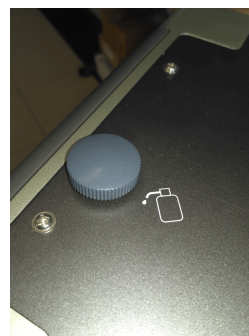
Punto de engrase para un adecuado mantenimiento del equipo.
