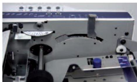
TF MEGA-A: Ajuste de la presión y separación del papel para diferentes pesos de éste
