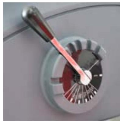
Ajuste de distancia entre rodillos. Max. 6mm
